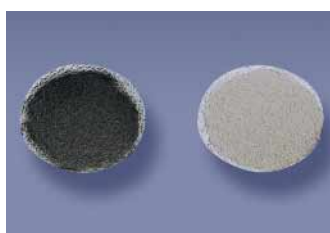
Quantità di fuliggine in filtro di Carta tre minuti dopo l'avviamento a freddo. Con il postriscaldamento (a destra) la quantità di fuliggine è di ca. 40 % inferiore.
