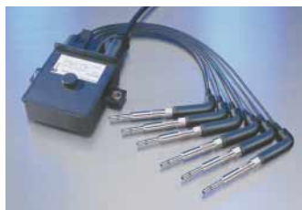
Sistema di incandescenza a controllo elettronico ISS: Centralina elettronica e candele a resistenza elettrica.
